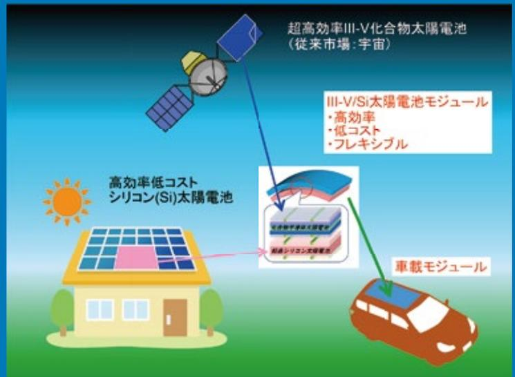
高効率な化合物半導体太陽電池と低コストな結晶シリコン太陽電池を組み合わせることにより、車など移動体への搭載に必要な35%以上の高い高効率と200円/Wの低コストの実現を目指します。
