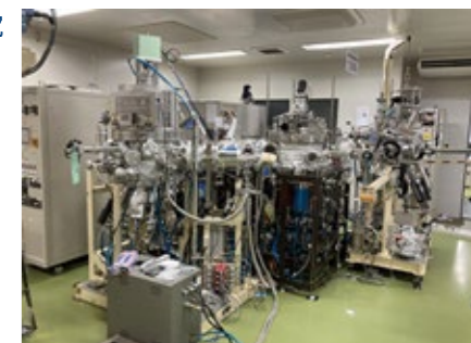
3台のマグネトロンパック装置を連結した多機能成膜装置。真空を破ることなく13種類の元素を自由に積層することが可能。
