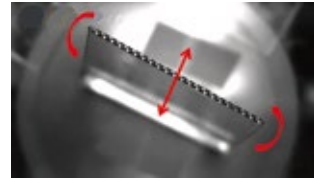
流れ中で自励振動する柔軟翼
