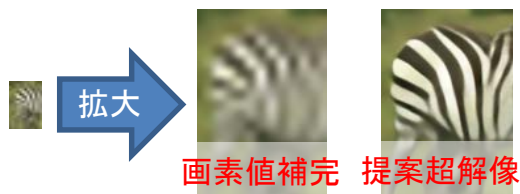
図4: 画像の超解像と, 遠方物体検出への応用
