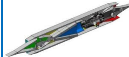
中型極超音速エンジン (推力1tonf級)
